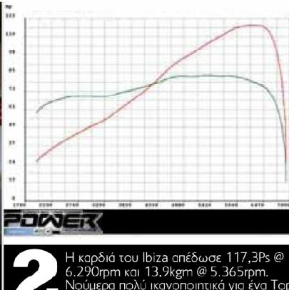
2 Η καρδιά του Ibiza απέδωσε 117,3Ps @ 6.290rpm και 13,9kgm @ 5.365rpm. Νούμερα πολύ ικανοποιητικά για ένα Top Gun με τόσες χιλιάδες χιλιόμετρα!
